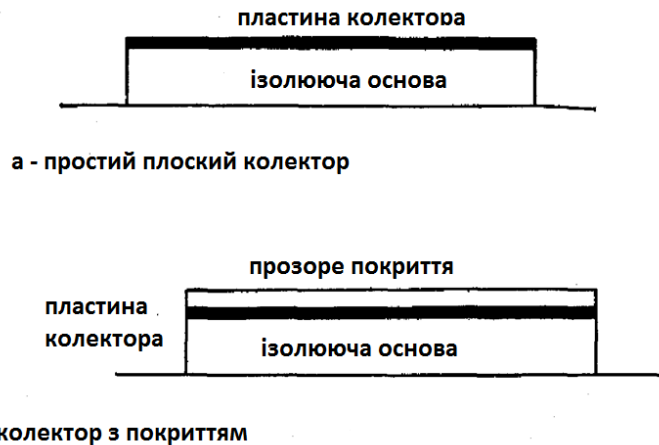
Рис. 1. Плоскі сонячні колектори.[3]
