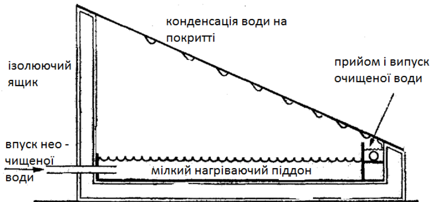
Рис. 2. Простий сонячний опріснювач. [4]
