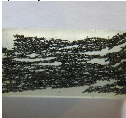
Рис. 3. Структура ПКМ на основі ЕД-20 і Fe
