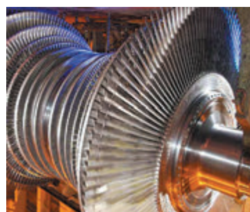
Рис. 17.3. В современных турбинах для максимального использования энергии пара применяют несколько дисков с лопатками, насаженных на один общий вал
