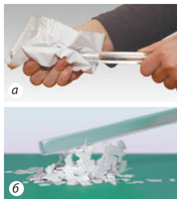
Рис. 19.1. Чтобы наэлектризовать палочку из оргстекла, достаточно потереть ее листом бумаги (а). После этого палочка начинает притягивать к себе разные мелкие предметы (б)
