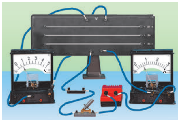
Рис. 30.2. Опыт, доказывающий, что сопротивление проводника обратно пропорционально площади его поперечного сечения
