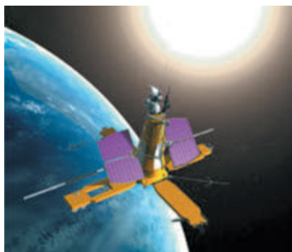
Рис. 25.3. Солнечные батареи спутника дистанционного зондирования Земли обеспечивают электроэнергией всю исследовательскую аппаратуру. Солнечные батареи преобразуют энергию света в электрическую энергию
