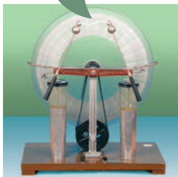
Рис. 40.1. Искровой разряд между заряженными кондукторами электрофорной машины
