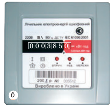
Рис. 33.1. Снятие показаний счетчика: а — первоначальные данные (382 кВт·ч); б — данные счетчика после некоторого времени работы электрообогревателя (385 кВт·ч). Количество использованной за это время электроэнергии: 385 - 382 = 3 (кВт·ч)
