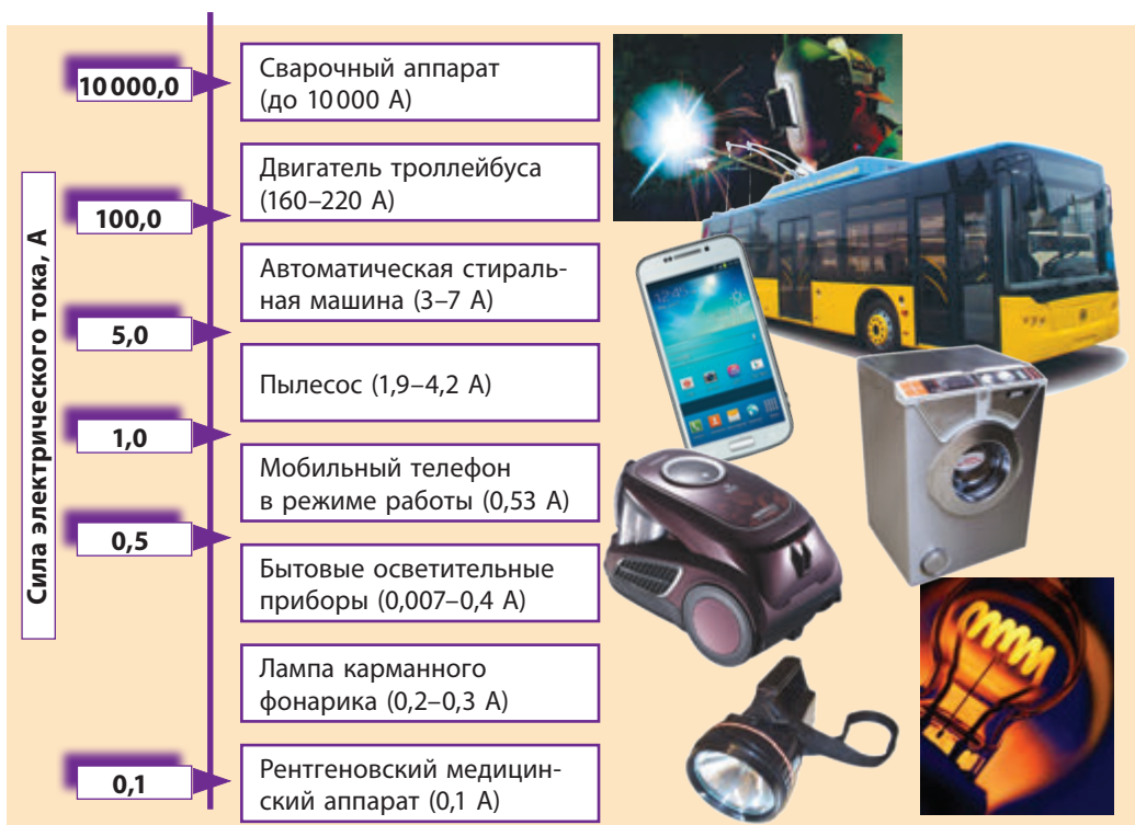
Рис. 27.4. Значения силы тока в некоторых электротехнических устройствах
