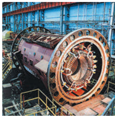
Рис. 25.2. Благодаря турбогенераторам, преобразующим механическую энергию вращения турбин в энергию электрического тока, вырабатывается 80 % потребляемой в мире электроэнергии
