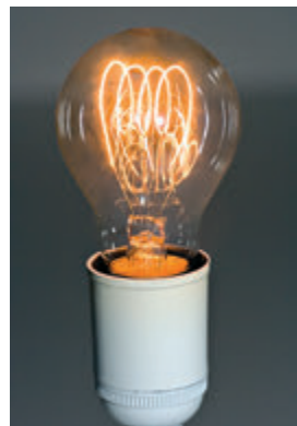
Рис. 35.3. Нагревательный элемент электрической лампы накаливания изготавливают из вольфрама, температура плавления которого 3387 °С. Нагреваясь до температуры 3000 °С, тонкая вольфрамовая нить начинает ярко светиться
