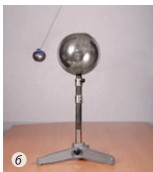
Рис. 21.3. Электризация сферы через влияние (а); индикатором наличия заряда служит положительно заряженный шарик — он отклоняется от сферы, значит, сфера (в отличие от палочки) заряжена положительно (б)
