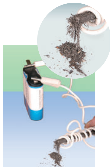
Рис. 24.5. Во время прохождения тока гвоздь становится магнитом и притягивает к себе железные опилки
