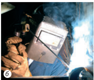
Рис. 40.9. Применение дугового газового разряда для плавки (а) и сварки (б) металлов
