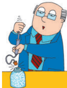
Рис. 4.5. Опыт, подтверждающий, что при выполнении воздухом работы его внутренняя энергия уменьшается. Доказательство — появление тумана
