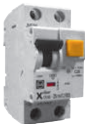
Рис. 35.5. Автоматические предохранители. Рабочая часть автоматического предохранителя — биметаллическая пластина. В случае увеличения силы тока сверх нормы биметаллическая пластина выгибается, в результате чего цепь размыкается. После охлаждения предохранитель снова можно вернуть в рабочее состояние
