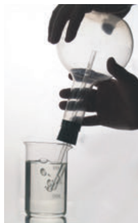
Рис. 2.1. Нагреваясь, воздух в колбе расширяется, и некоторая его часть выходит из колбы — у отверстия трубки образуются пузырьки воздуха
