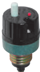
Рис. 35.5. Автоматические предохранители. Рабочая часть автоматического предохранителя — биметаллическая пластина. В случае увеличения силы тока сверх нормы биметаллическая пластина выгибается, в результате чего цепь размыкается. После охлаждения предохранитель снова можно вернуть в рабочее состояние
