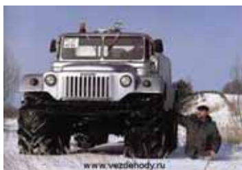
Мал. 149. Для зменшення тиску колеса транспортних засобів роблять ширшими
