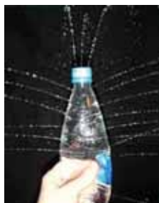
Мал. 167. Саморобний прилад для демонстрації закону Паскаля
